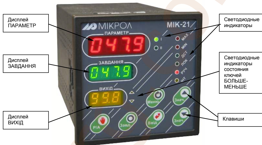
Рисунок 5.1 - Внешний вид передней панели регулятора МИК-21-05
