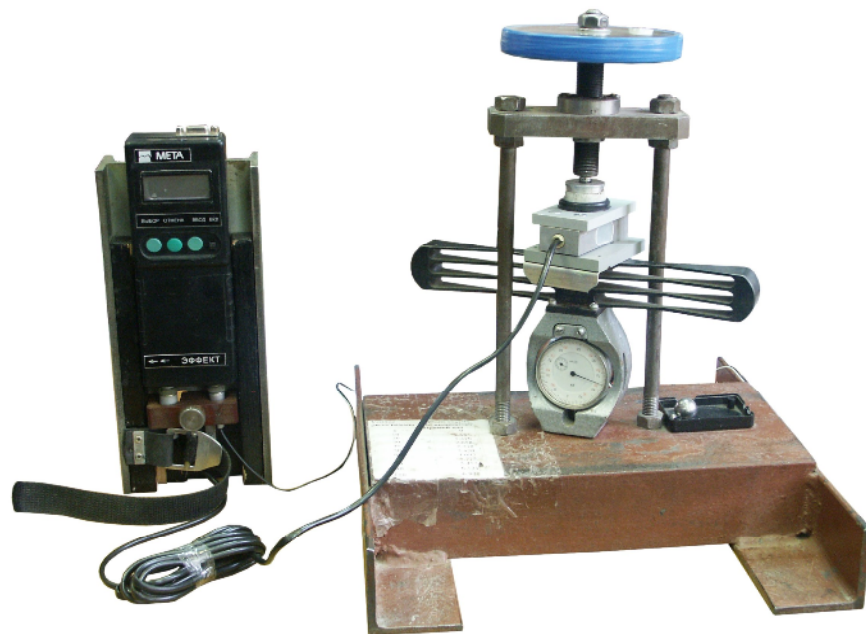
Установка датчика усилия в силозадающее устройство
