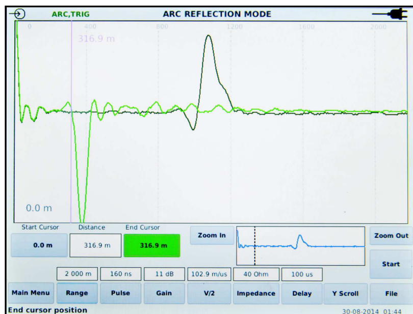
Рисунок 39 – Режим «ARC», короткое замыкание в кабеле во время подачи высокого напряжения на расстоянии 316,9 м
