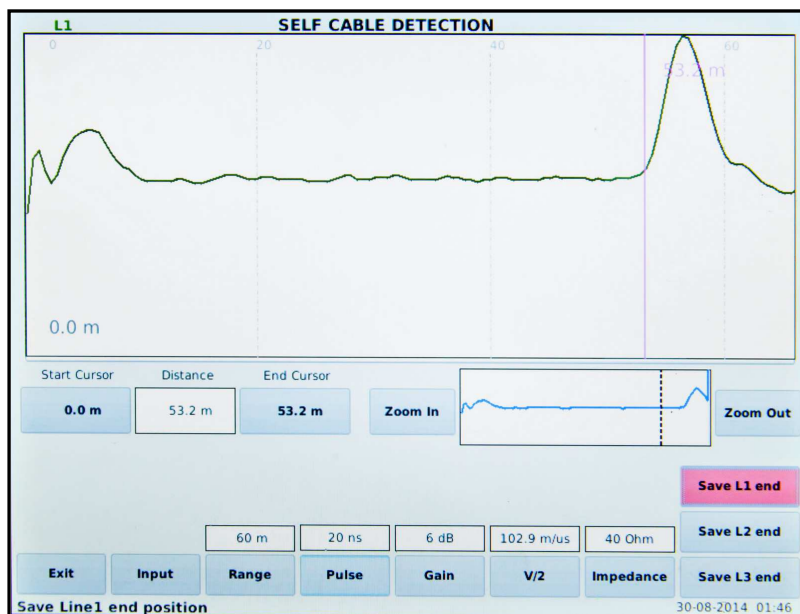
Рисунок 41 – Курсор установлен в конце кабеля ЭТЛ на расстоянии 53,2 м
