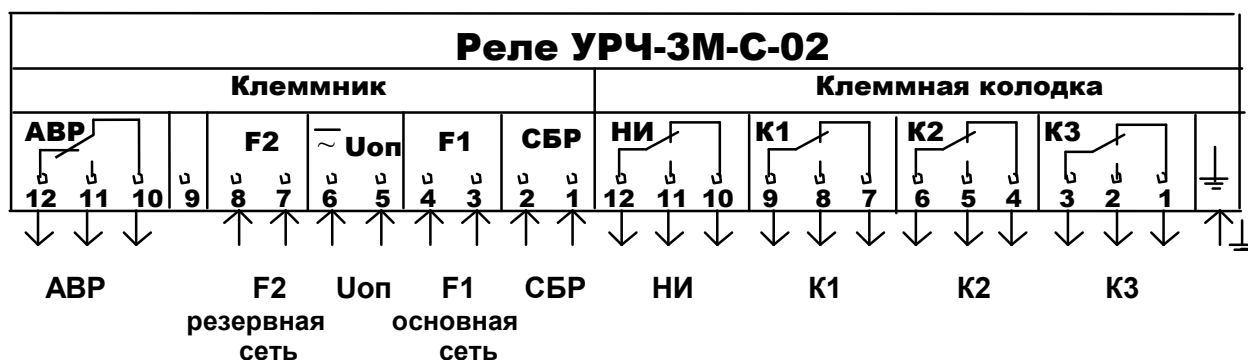
Рисунок Б.5 – Реле УРЧ-3М-С-02 в схемах автоматики
