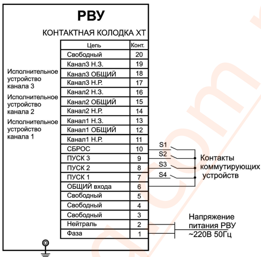
Схема внешних подключений реле РВУ
