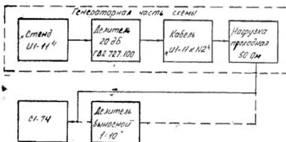
Рис. 16а. Схема соединения приборов при проверке неравномерности ПХ осциллографа с блоком Я40-1100 (1У11)
