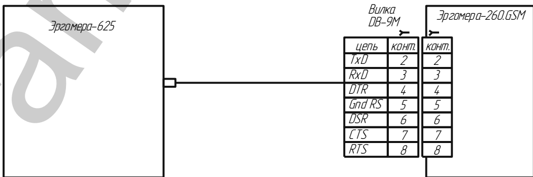
Подключение адаптера интерфейса Serial/GSM "Эргомера-260.GSM"
