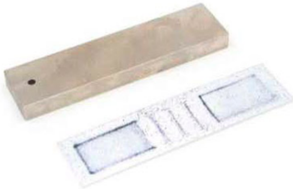
Рис. 5. Образец МО-3 и выявляемая на нем дефектограмма искусственных дефектов
