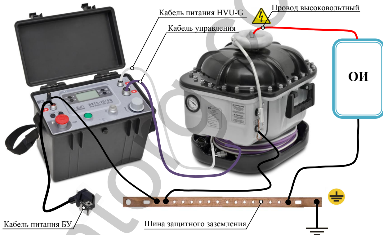
Рисунок 13 – Схема соединения Аппарата с ОИ
