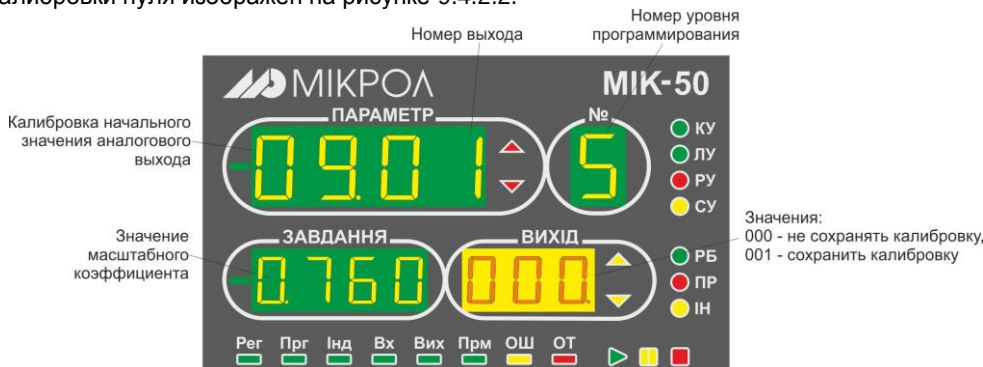
Рисунок 9.4.2.2 - Внешний вид индикаторов при калибровке конечного значения аналогового выхода
