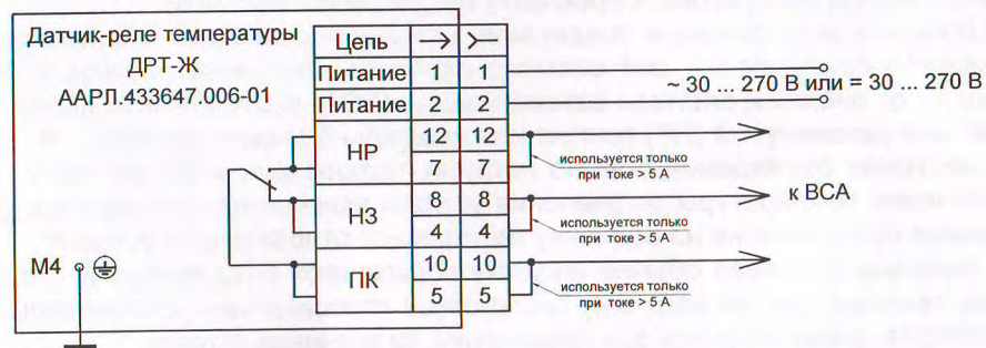
Рисунок 2 - Схема подключения ДРТ-Ж.
