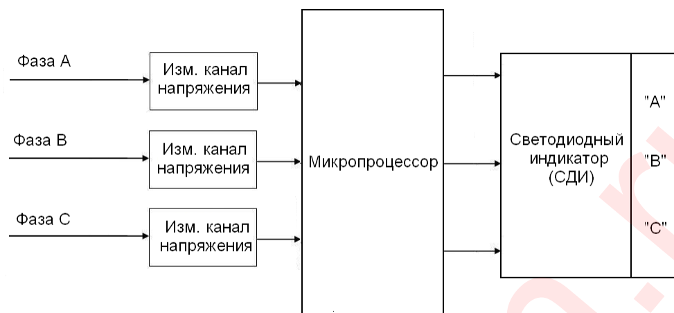
Рис. 6.2 – Структурная схема фазоуказателя
