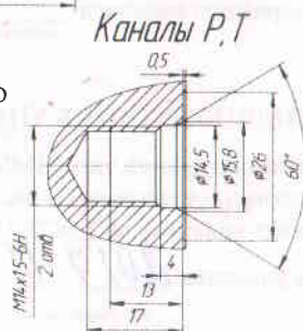
Рис. 1 Устройство, габаритные и присоединительные размеры ручного насоса типа HMM 14.16
