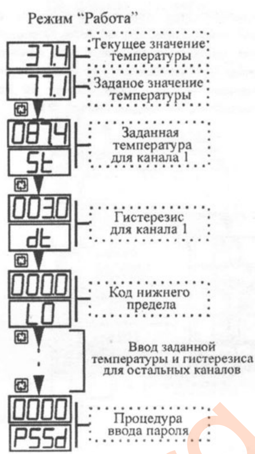
Рисунок 7 – Схема алгоритма работы прибора при типе логики работы выхода "01" и "02"
