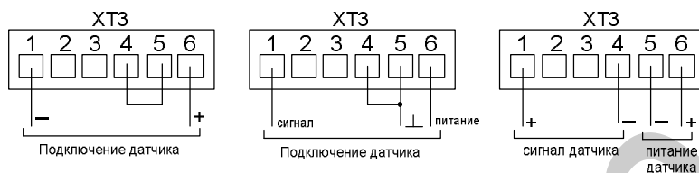
Подключение датчиков к прибору ИП-7-ТК-XXX-ДУУ
