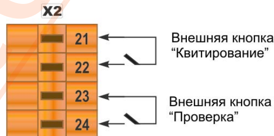
Рисунок А.3 - Подключение внешних кнопок сигналов «Проверка» и «Квитирование» к устройству аварийной сигнализации УАС-16(УАС-16МІ)
