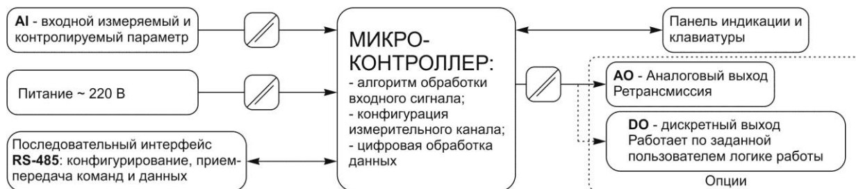
Рисунок 3.2 - Структурная схема вольтметра ИПМ-2
