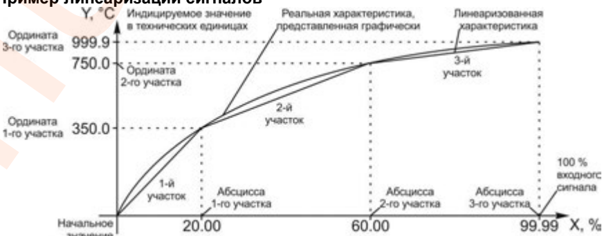
Рисунок 3.7 - Линеаризация сигнала, подаваемого на вход AI1, представленная графически (кривой)
