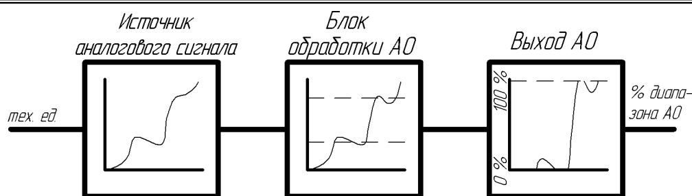
Рисунок 3.8 – Работа блока аналогового вывода в режиме ретрансмиссии
