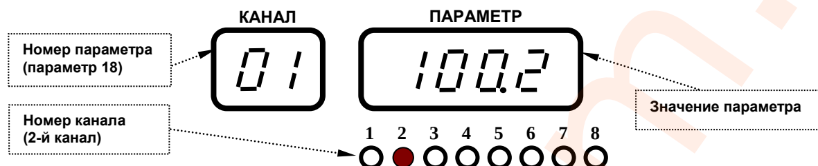
Рисунок 4.3 - Индикация значения номера канала, номера параметра и его значения
