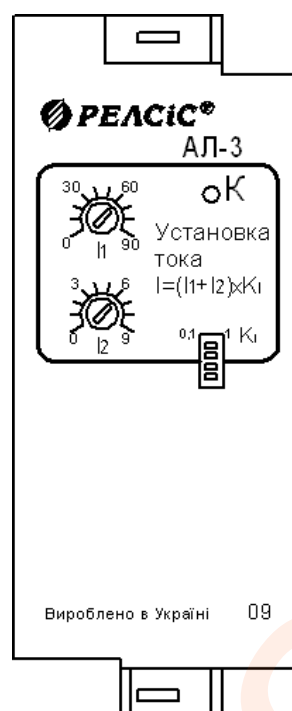
Рисунок 3 – Внешний вид лицевой панели и органов управления реле АЛ-3
