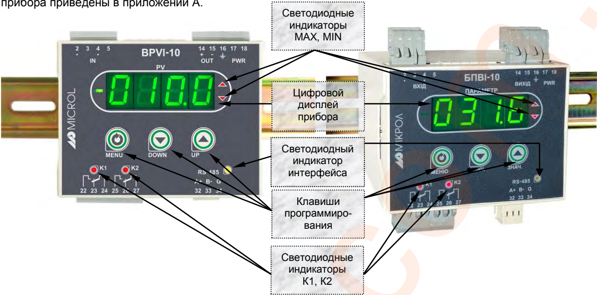
а) Исполнение передней панели на русском языке б) Исполнение передней панели на английском языке Рисунок 3.1 - Внешний вид передней панели преобразователя BPVI-10 (БПВИ-10)
