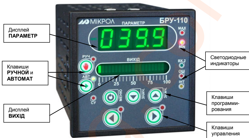
Рисунок 3.1 - Внешний вид передней панели блока ручного управления БРУ-110
