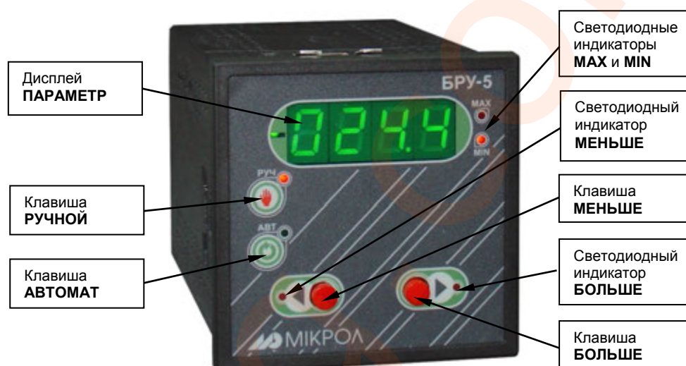
Рисунок 5.1 - Внешний вид передней панели блока ручного управления БРУ-5
