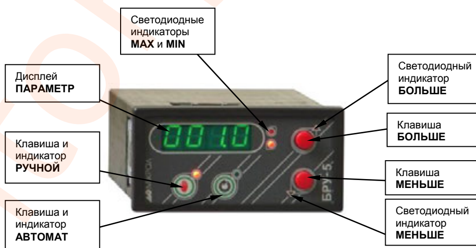
Рисунок 5.2 - Внешний вид передней панели блока ручного управления БРУ-5К1
