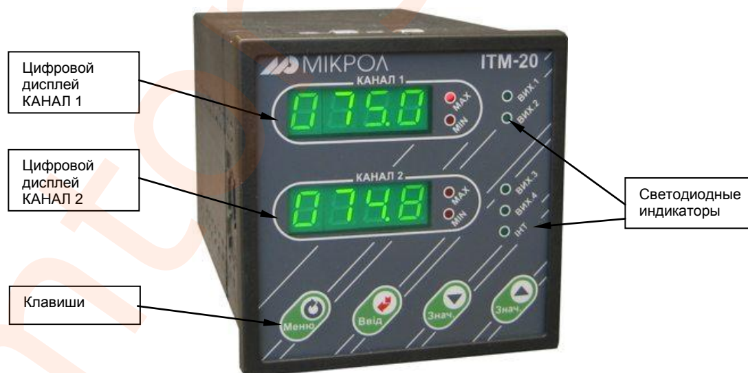
Рисунок 3.2 - Внешний вид передней панели индикатора ИТМ-20
