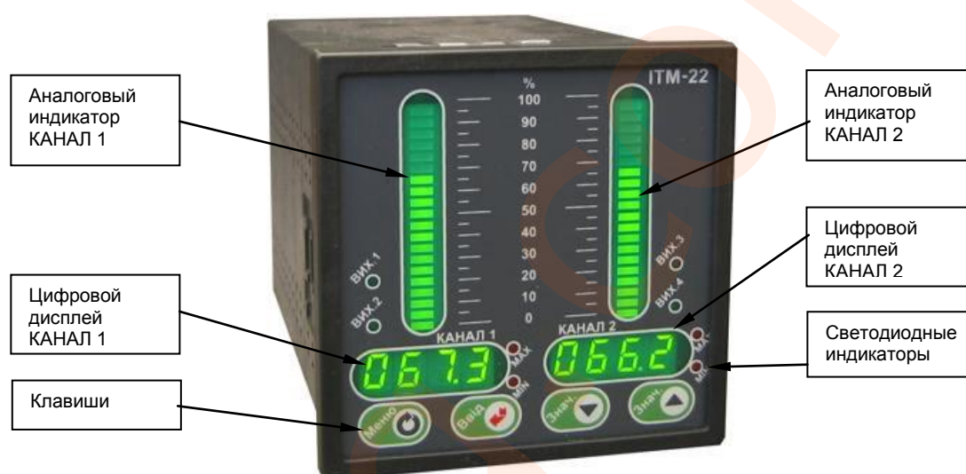
Рисунок 3.1 - Внешний вид передней панели индикатора ИТМ-22
