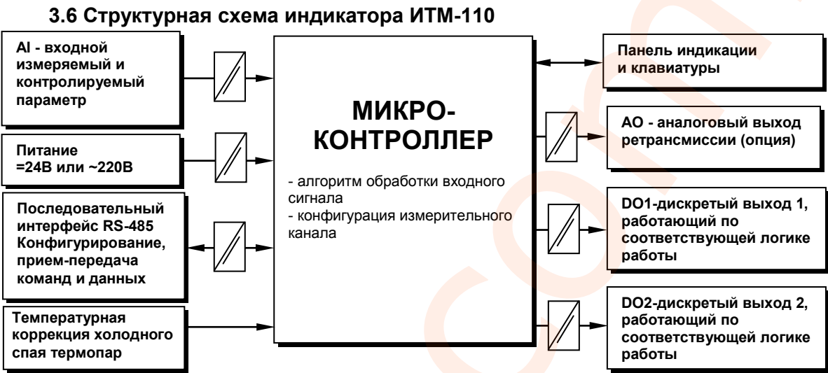
Рисунок 3.2 - Структурная схема индикатора ИТМ-110
