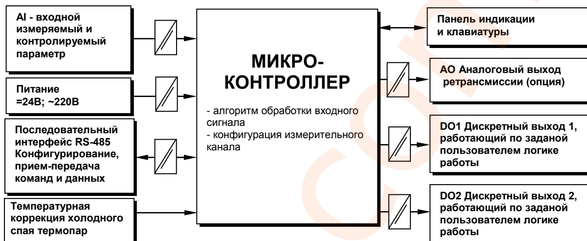
Рисунок 3.2 - Структурная схема индикатора ИТМ-111Н
