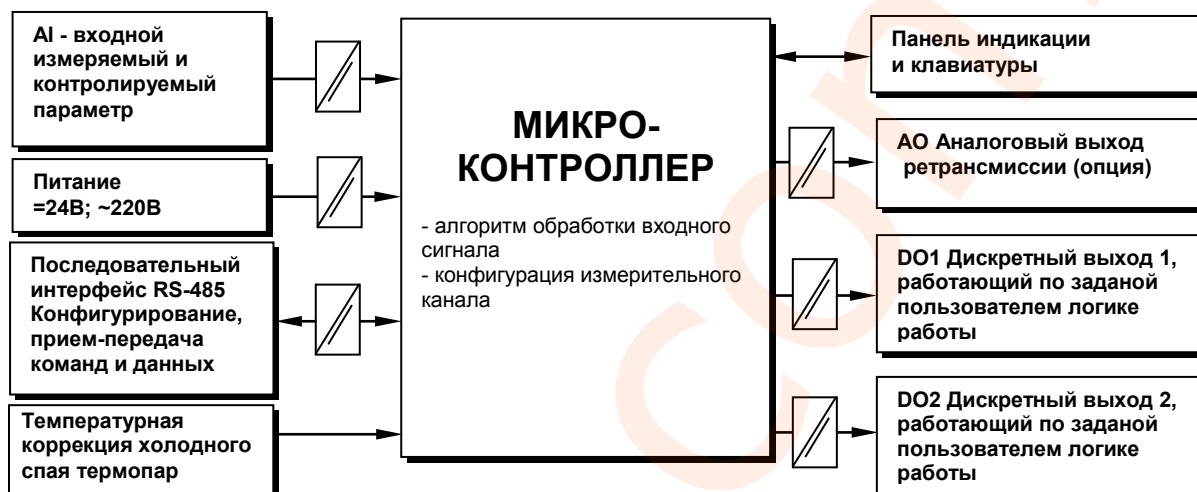
Рисунок 3.2 - Структурная схема индикаторов ИТМ-111, ИТМ-111В
