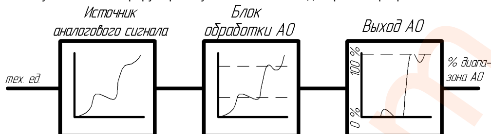
Рисунок 3.6 – Работа блока аналогового вывода в режиме ретрансмиссии
