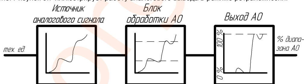
Рисунок 3.6 – Работа блока аналогового вывода в режиме ретрансмиссии
