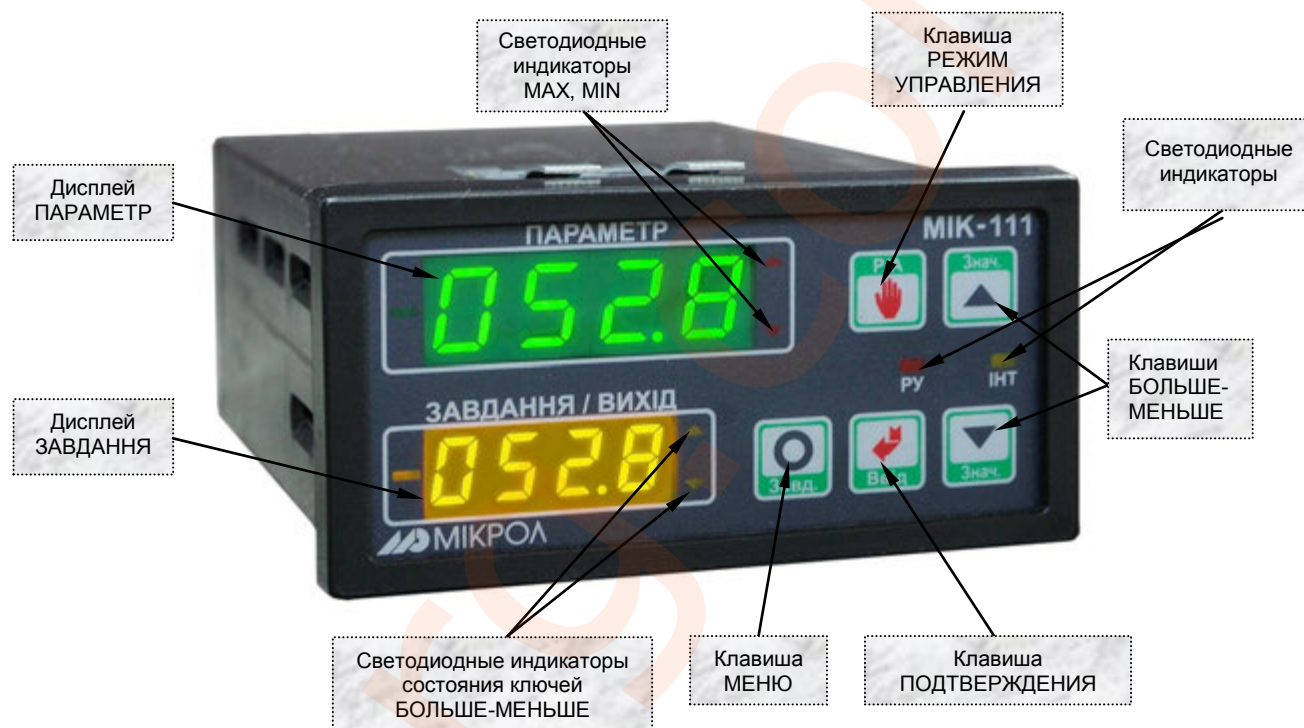
Рисунок 3.1 - Внешний вид передней панели регулятора МИК-111
