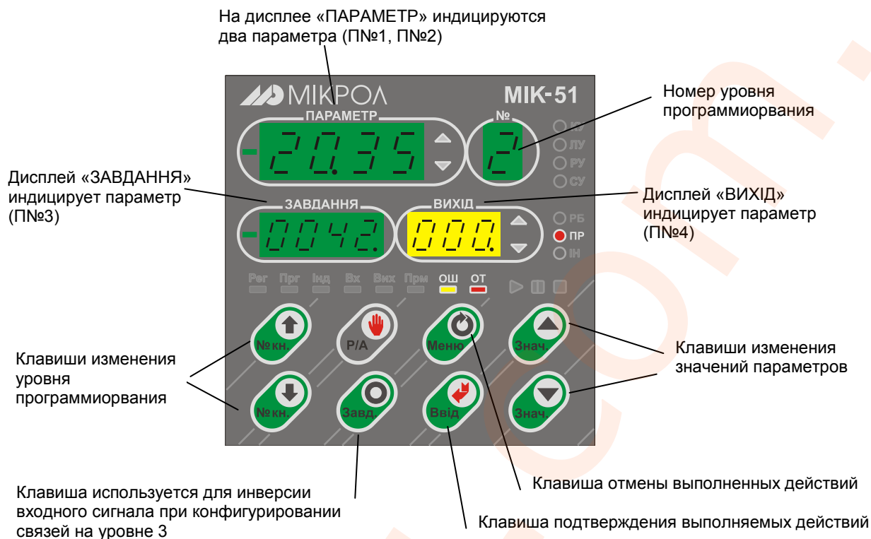
Рисунок 7.1 - Лицевая панель контроллера МИК-51 в режиме программирования
