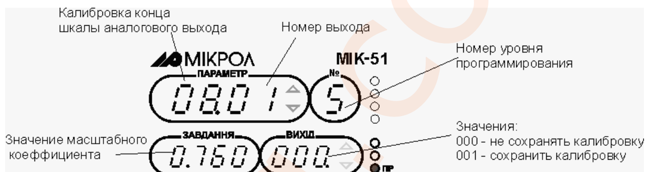
Рис 11.4.2.2 Внешний вид индикаторов при калибровке конечного значения аналогового выхода
