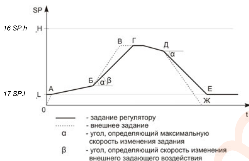
Рисунок 8.60.7 – Диаграмма ограничения скорости внешнего задания
