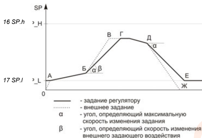
Рисунок 8.90.7 – Диаграмма ограничения скорости внешнего задания
