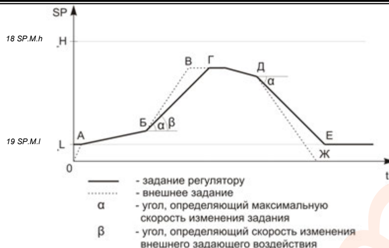
Рисунок 8.61.4 – Диаграмма ограничения скорости внешнего задания
