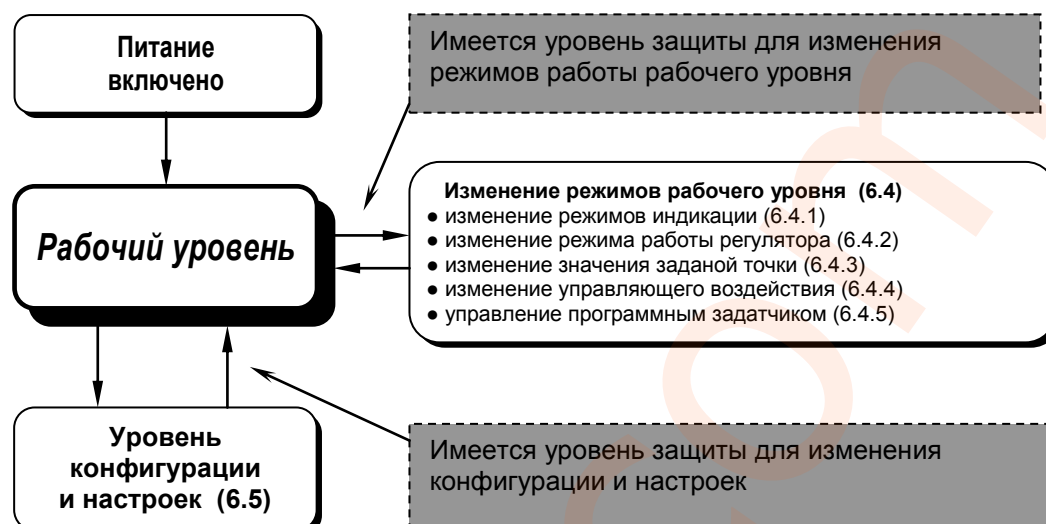
Рисунок 6.1 - Диаграмма уровней работы, защиты и настроек регулятора МТР-44
