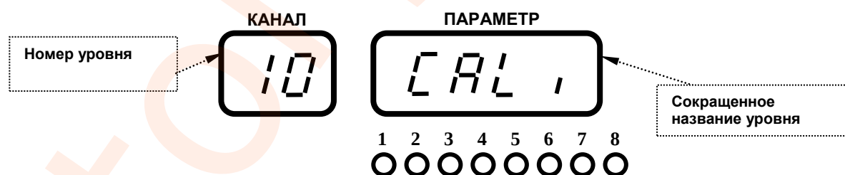
Рисунок 6.3 - Индикация номера уровня и его названия
