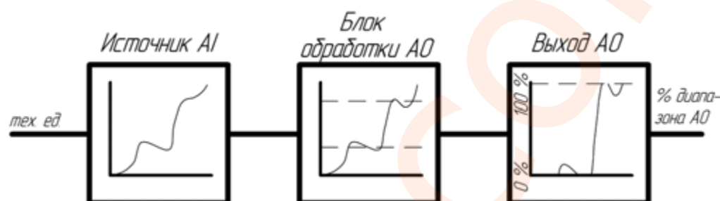
Рисунок 5.4 – Работа блока аналогового вывода в режиме ретрансмиссии
