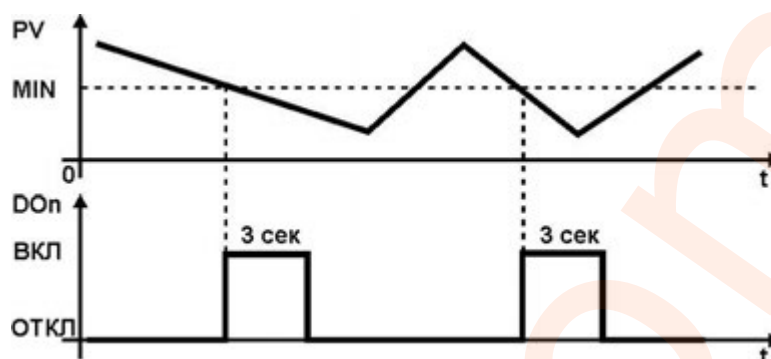
Рисунок 5.10 – График работы дискретного выхода при импульсном типе выходного сигнала
