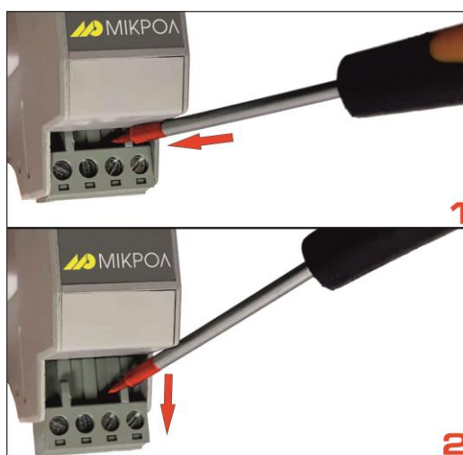
Рисунок 3.3 – Схема извлечения разъем-клеммы с помощью плоской отвертки
