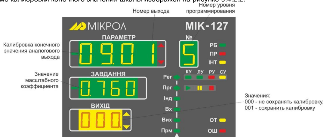
Рисунок 9.4.2.2 - Внешний вид индикаторов при калибровке конечного значения аналогового выхода
