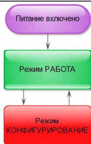
Рисунок 4.1 - Диаграмма режимов работы и настройки индикатора ИТМ-16
