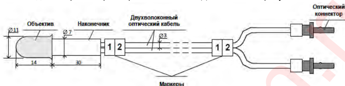
Рисунок 2.1 – Внешний вид и габаритные размеры объектива ВОД
