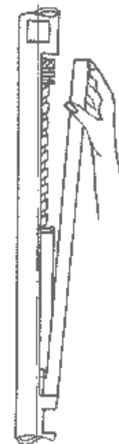
Рисунок 1 – Развинчивание корпуса манометра
