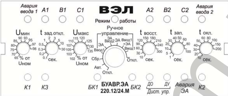
Рис. 2 Расположение органов управления и индикации БУАВР.ЭА
