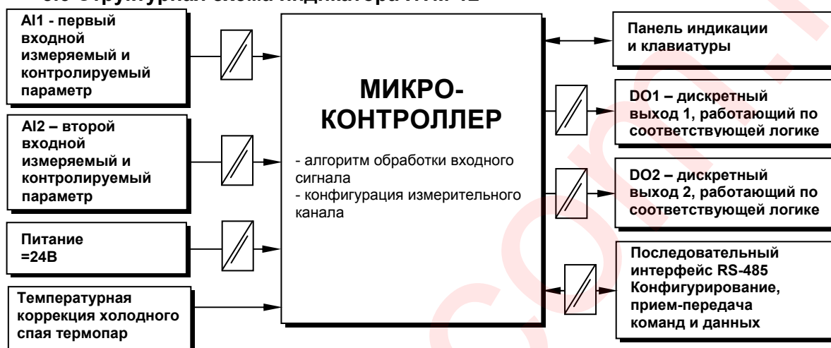
Рисунок 5.2 - Структурная схема индикатора ИТМ-12
