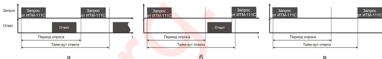
Рисунок 2.4 - Временные диаграммы приема-передачи данных ИМТ-115 в режиме MASTER
