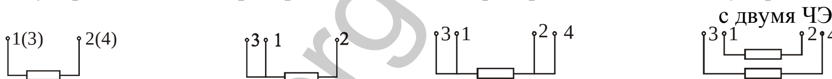
Рисунок 1 – Схемы внутренних соединений ТС с ЧЭ
