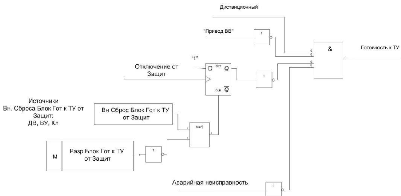
Рис. 1.7.14 Функциональная схема блока готовности к ТУ
