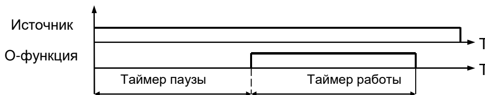
Рис. 1.7.15.1 Диаграмма работы определяемой функции, тип функции – прямая
