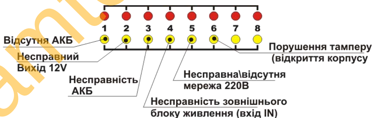
Рисунок 5.2 – Розширена індикація несправностей живлення для Тірас-8П.1
