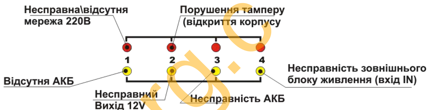
Рисунок 5.1 – Розширена індикація несправностей живлення для Тірас-4П.1
