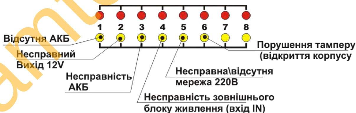
Рисунок 5.2 – Розширена індикація несправностей живлення для Тірас-8П.1
